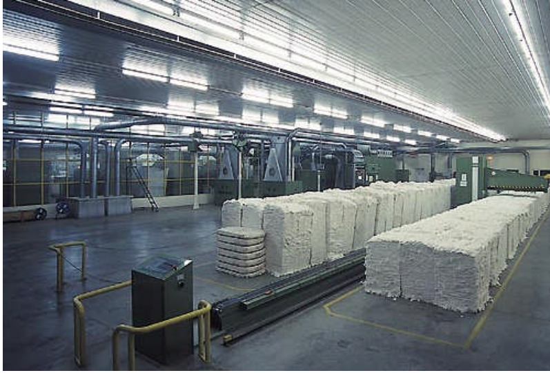
Resim 1.3:Pamuk balyalarının makineye yerleştirilmesi
