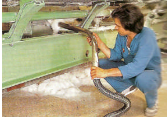
Resim 2.4:Klasik balya açma makinesi temizliđi
